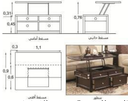
شكل (6) تحليل هندسي للمنضدة في حالة إرتفاعها موضح به الأبعاد الهندسية
